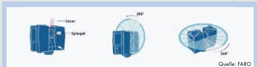
Ein rotierendes Spiegelsystem lenkt den Laserimpuls in der Vertikalen um 305° um, während in der Horizontalen 360° durch die Drehung des Gerätes erreicht werden. Damit wird der den Scanner umgebende Raum fast vollständig erfasst. Abschattungen werden durch Scans aus verschiedenen Blickwinkeln eliminiert.
